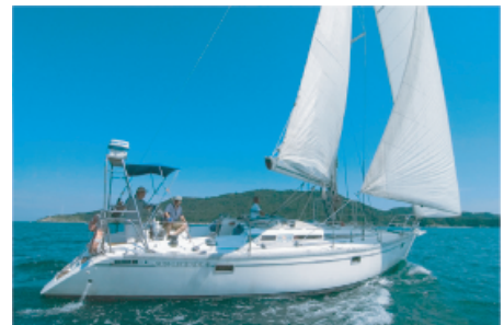
全長L.O.R.: 12m45 ハル長さL.H.: 12m25 吃水線長さL.W.L.: 9m98 最大ビーム: 3m94 固定キール吃水: 1m9 固定キール排水量: 7,300kg
